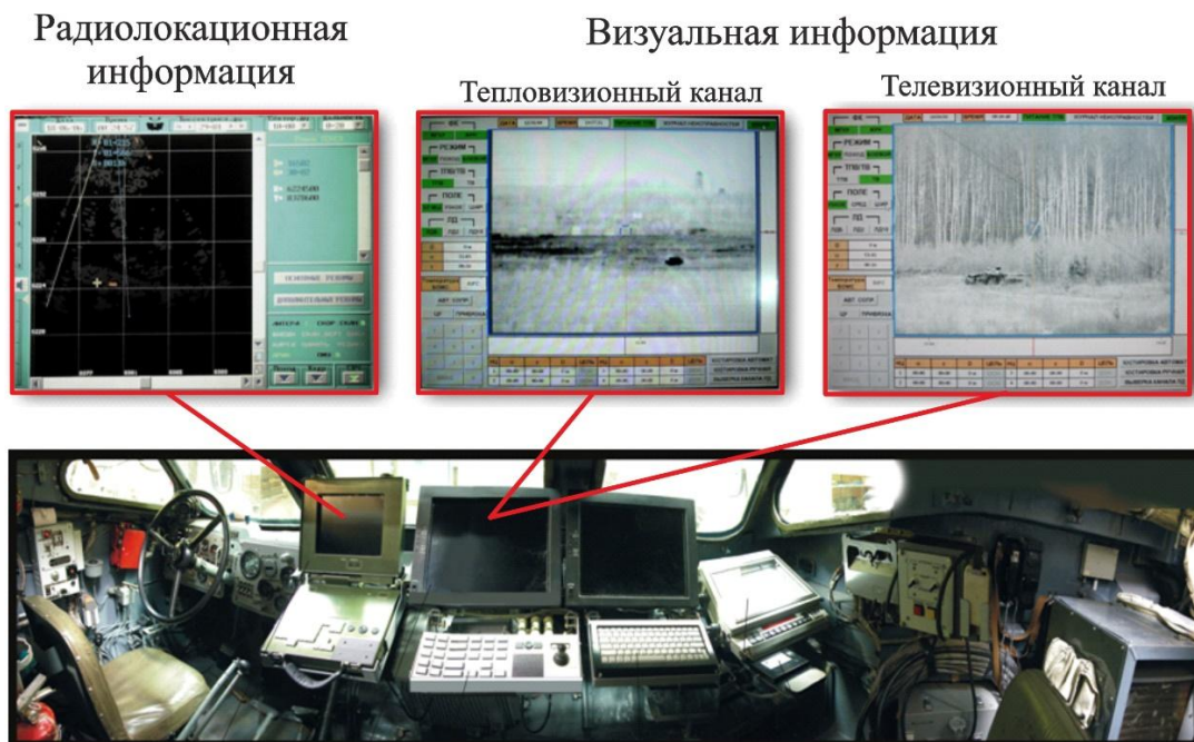
Рис. 2. Вывод радиолокационной и визуальной информации на разные мониторы в комплексе «Кредо-1С»
