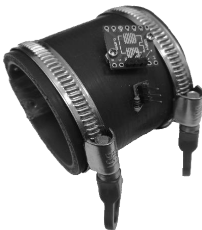
Рис. 7. Адаптивный блок с датчиками MPXHZ6400AC6T1 и DS18B20.
