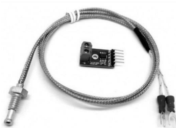
Рис. 3. Датчик температуры MAX6675 с АЦП.
