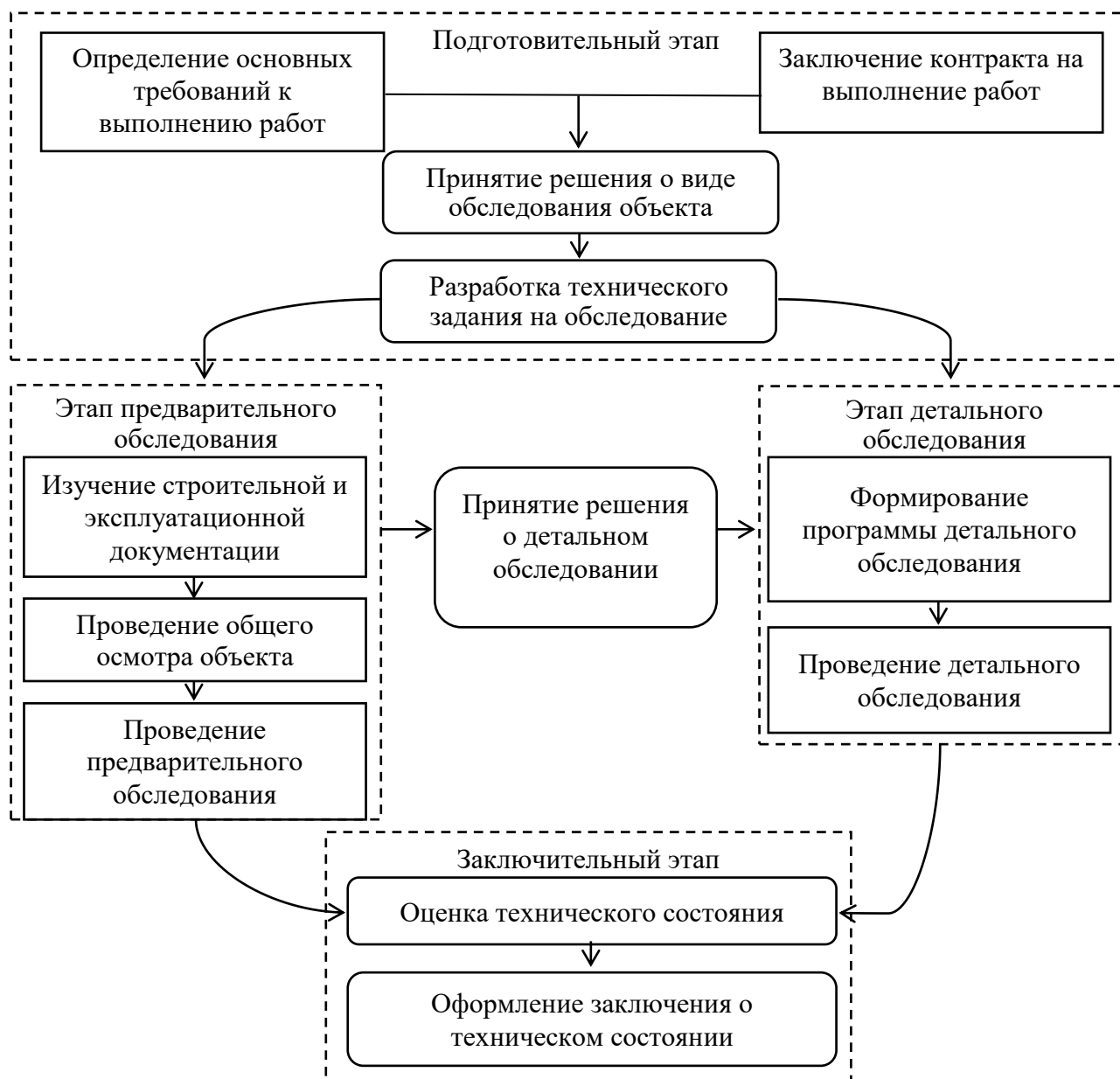
Рис. 6. Алгоритм проведения обследования технического состояния здания
